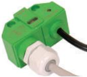
**Conexão por Prensa Cabo e Cabo** - Nesta versão, o monitor é fornecido com cabo DeviceNet fino que transmite a posição aberta ou fechada da válvula e recebe o comando para acionamento da solenóide, um segundo cabo é responsável pela conexão da válvula solenóide. Disponível somente para DeviceNet.
