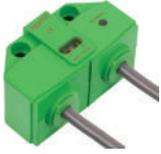
**Conexão por Cabo ( Com saída para solenóide )** - Nesta versão, o monitor possui um cabo para conexão com o sistema de controle, onde indicam a posição da válvula e recebem o comando para acionamento da solenoide. O segundo cabo do monitor, transmite o comando de acionamento vindo do controlador lógico para a solenoide.
