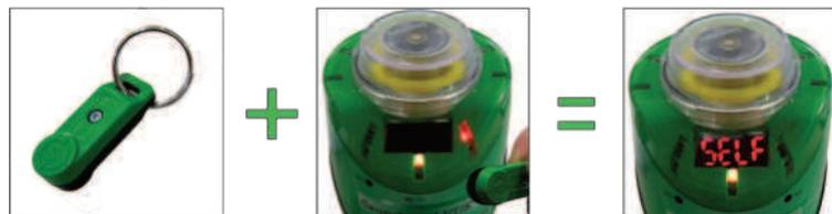
A válvula solenoide será acionada para controlar o atuador em 3, 5 ou 10 ciclos consecutivos para aprender a posição aberta e fechada da válvula de acordo com o deslocamento do eixo.
