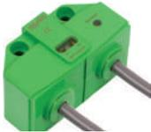
**Conexão por Cabo** - Nesta versão, o monitor possui um cabo de conexão para a rede que transmite a posição aberta ou fechada da válvula e recebe o comando para acionamento da solenóide e também um segundo cabo, responsável pela conexão da válvula solenóide que irá comandar o atuador para abertura ou fechamento da válvula. Disponível para AS-Interface ou DeviceNet.
