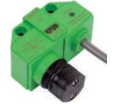
**Conexão por Cabo e Conector VY** - Nesta versão, o monitor possui um conector VY para a conexão da rede AS-Interface, que transmite a posição aberta ou fechada da válvula e recebe o comando para acionamento da solenóide e também um cabo, responsável pela conexão da válvula solenóide que irá comandar o atuador para abertura ou fechamento da válvula. Disponível somente para AS-Interface.
