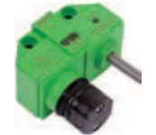
**Conexão por Cabo e Conector VY** - Nesta versão, o monitor possui um conector VY para a conexão da rede AS-Interface, que transmite a posição aberta ou fechada da válvula e recebe o comando para acionamento da solenoide e também um cabo, responsável pela conexão da válvula solenóide que irá comandar o atuador para abertura ou fechamento da válvula. Disponível somente para AS-Interface.
