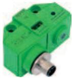
**Conector M12 ( Sem saída para solenóide )** - Nesta versão, o monitor possui apenas um conector para os sensores, responsáveis pela indicação da posição aberta ou fechada da válvula e transmitem o sinal para um cartão de entrada do sistema de controle, possibilitando assim a indicação remota de válvula aberta ou fechada.
